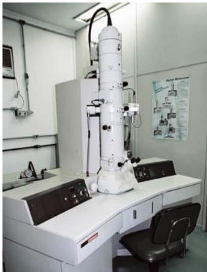
Figura 1.5 – Microscópio eletrônico de transmissão [11].
