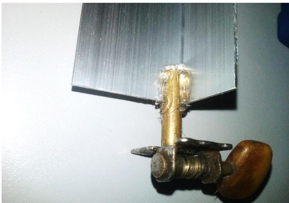
Figura 2.2: A placa de alumínio B foi presa com cola quente na abertura da tarraxa.
