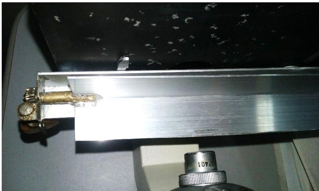
Figura 2.4: Placa de alumínio B que está presa à uma tarraxa, sendo que esta, por sua vez está presa à placa de alumínio A.
