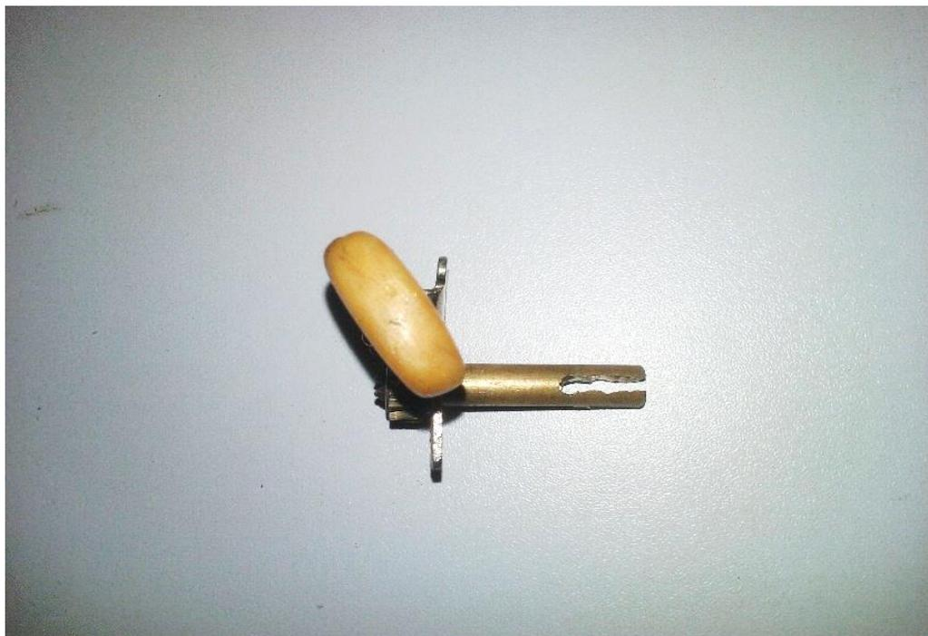
Figura 2.1: Uma tarraxa de violão com uma abertura feita por uma serra de ferro.
