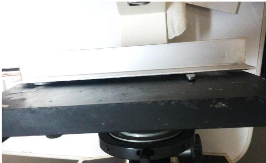
Figura 2.3: Placa de alumínio A presa com supercola ao microscópio.
