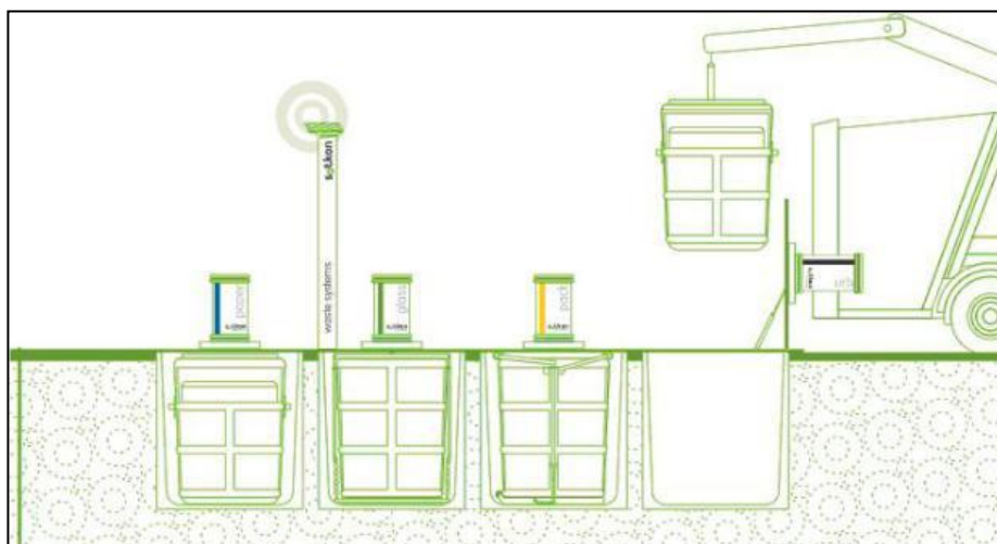
Figura 30 - Esquema do sistema de resíduos sólidos com contentores subterrâneos standard.
