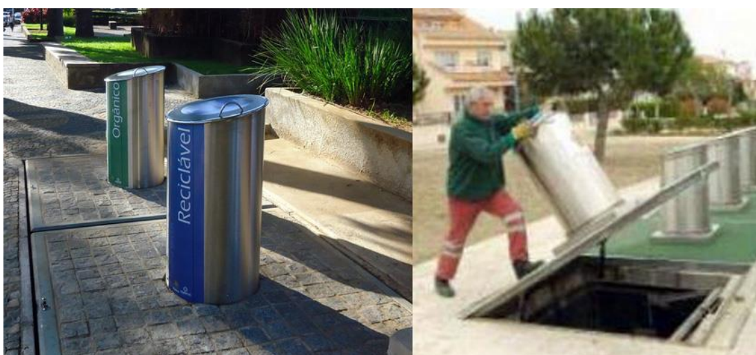
Figura 31 - Modelo de lixeira em aço inox e manobra de coleta do lixo armazenado.
