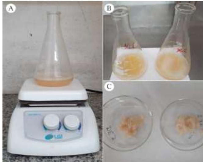
Figura 13 - Desproteinização das cascas *M. amazonicum*; (b) amostras após a desmineralização; (c) amostras filtradas e lavadas.
