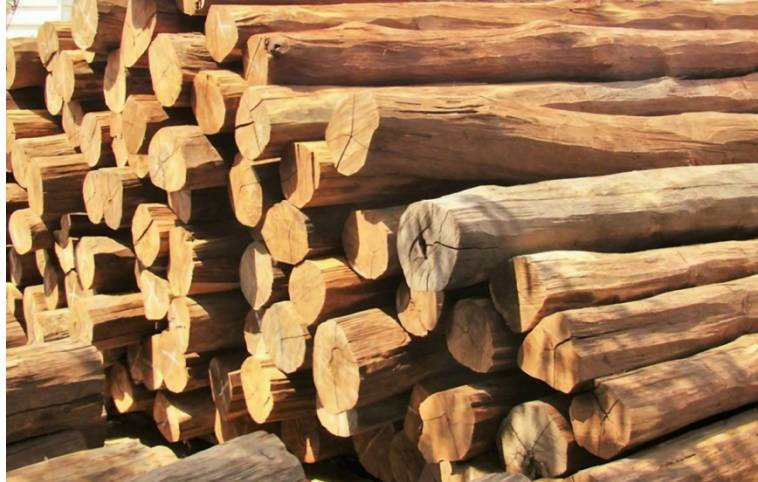
Figura 4 – Estacas de madeiras fabricadas de acordo com especificações do projeto de ponte de madeira
