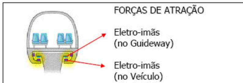
Figura 10: Princípio da Levitação por Atração Magnética
