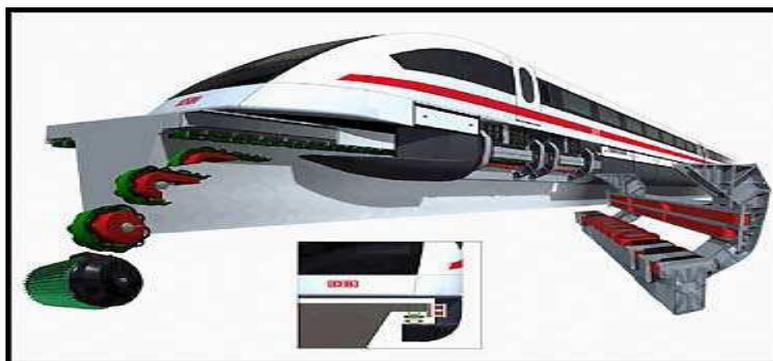
Figura 13: Princípio da Orientação Lateral.
