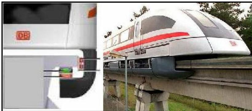
Figura 12: Princípio da Levitação Magnética.
