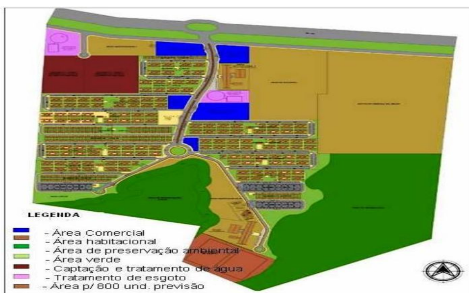
Figura 2 – Implantação geral do Conjunto Macapaba – Projeto urbano.
