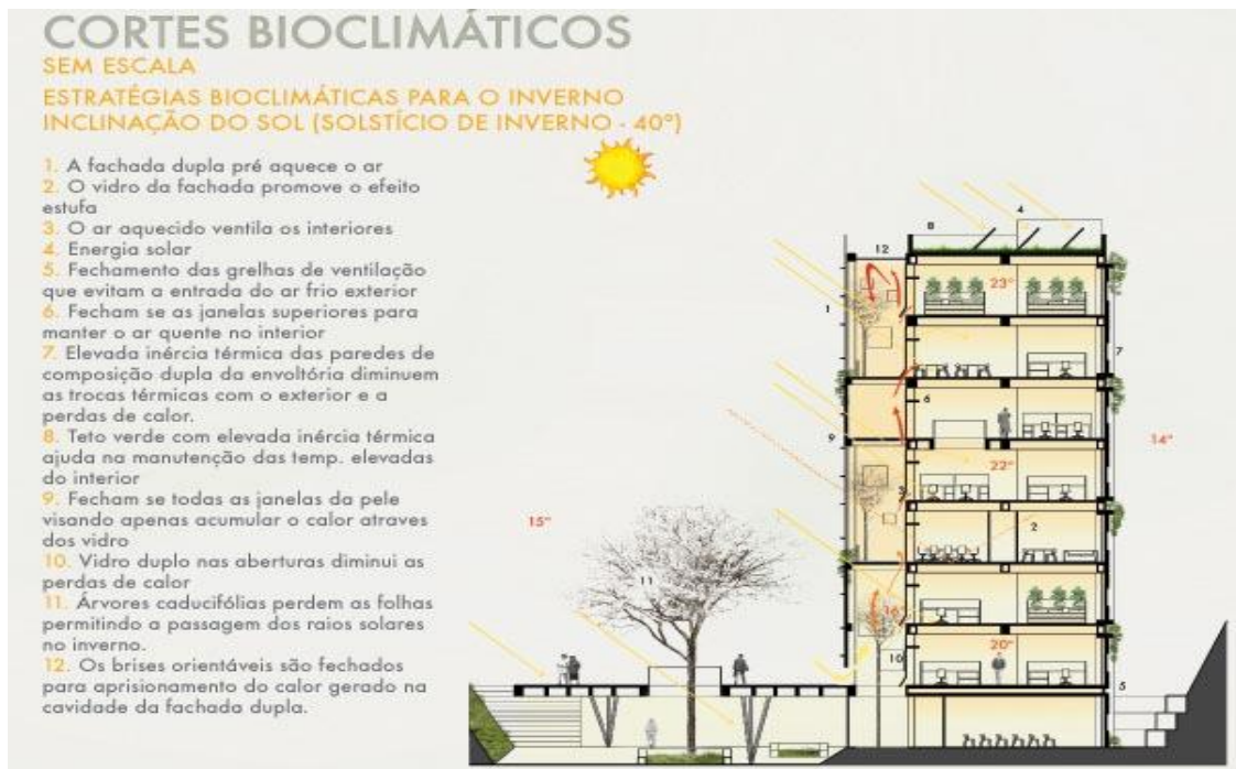
FIGURA 33 – Corte esquemático. Estratégias bioclimáticas para o inverno
