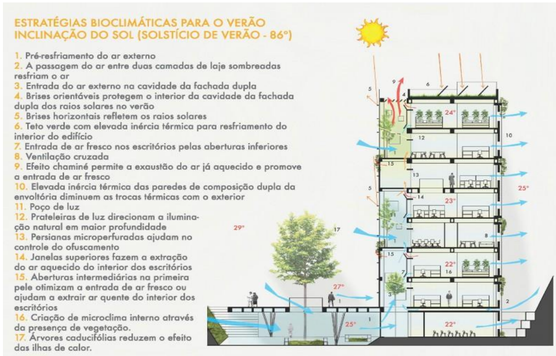
FIGURA 32 – Corte esquemático. Estratégias bioclimáticas para o verão
