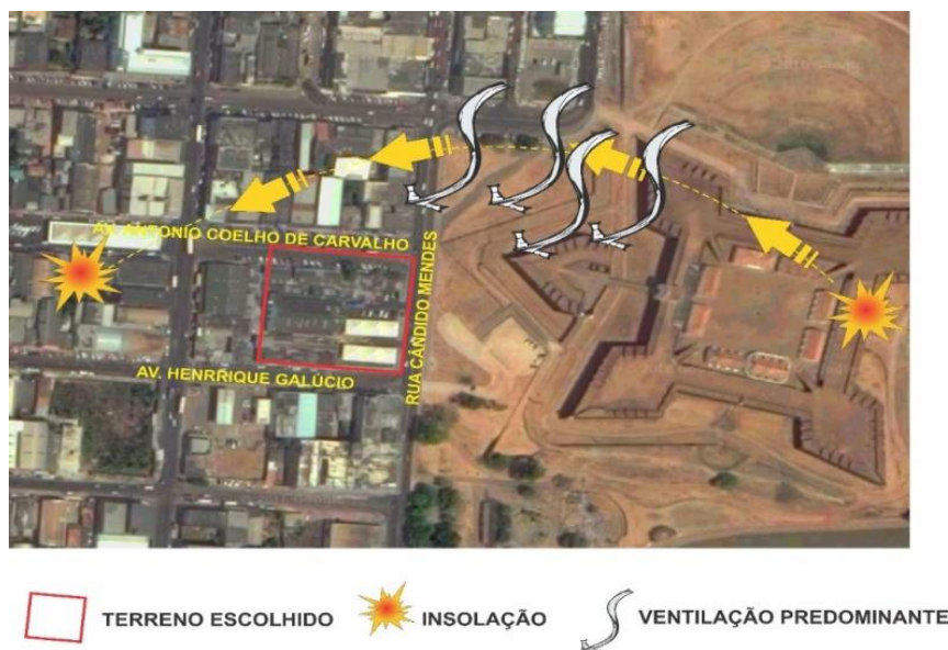
Figura 20: Ventilação e Orientação Solar.
