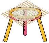
**Tripé e tela de amianto:** Usado para aquecimento, juntamente com o bico de busen.
