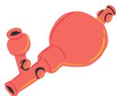
**Pêra:** Auxilia na sucção de líquidos da pipeta volumétrica ou graduada
