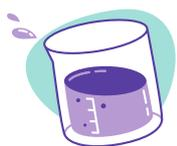
**Béquer:** Utilizado para o preparo de soluções em geral, dissolver soluções, mistura de reagentes,
