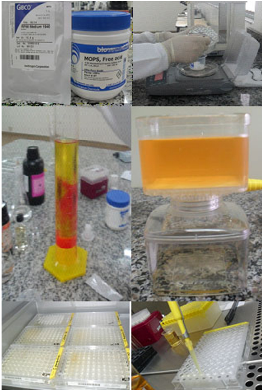
Figura 6 – Etapas de Execução do Teste de Microdiluição
