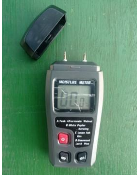
Figura 5: Medidor digital de umidade por penetração (Moisture Meter) empregado na mensuração da umidade do tronco das árvores monitoradas.
