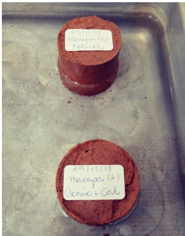
Figura 14 - Corpos de prova. Preparados segundo a NBR 9895.
