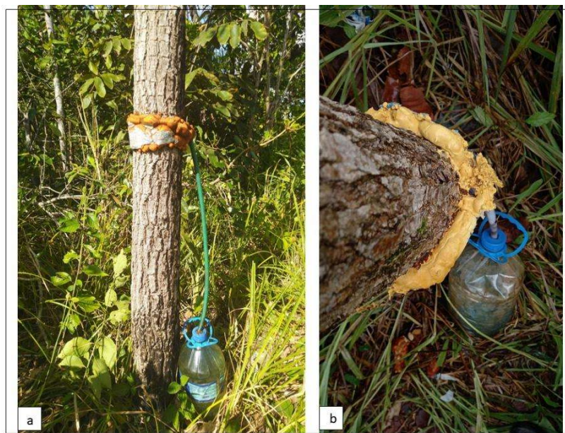
Figura 21 – Sistema de coletor de escoamento pelo tronco (Et): a) visão vertical; b) visão oblíqua
