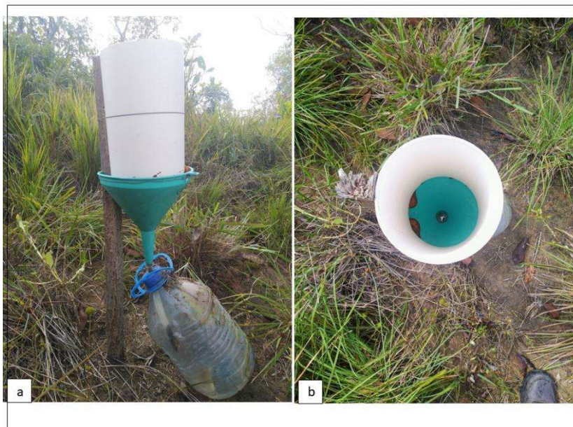
Figura 20 – Interceptômetro / Pluviômetro manual: a) visão vertical; b) visão oblíqua
