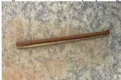
Figura 19 – Moldagem da amostra em comparação ao gabarito cilíndrico
