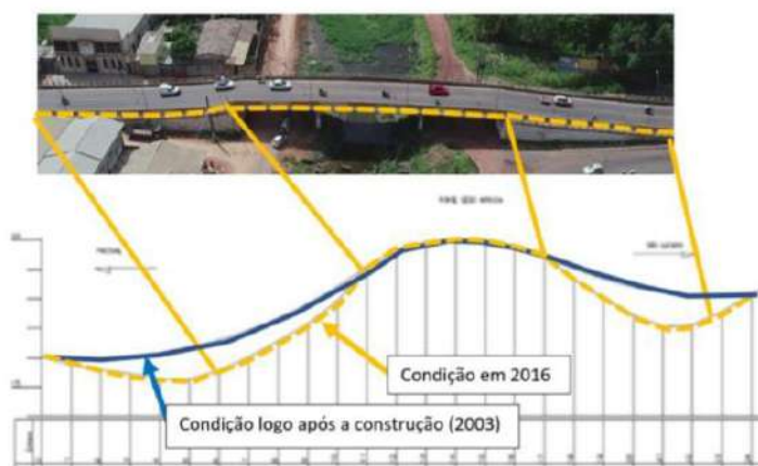
Figura nº 17: Perfil longitudinal da ponte após a construção da ponte e em 2016 (Laudo nº 102.116/2016 – DC/POLITEC/STN).
