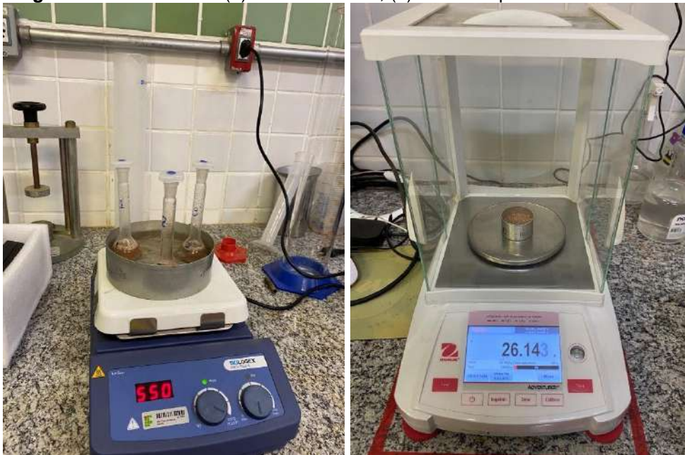
Figura 28 – Ensaio de: (a) Densidade real; (b) Umidade pelo método da estufa
