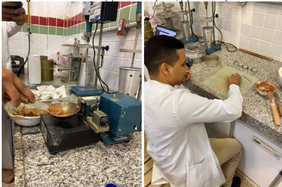
Figura 26 – Ensaios de: (a) Limite de liquidez; (b) Limite de plasticidade
