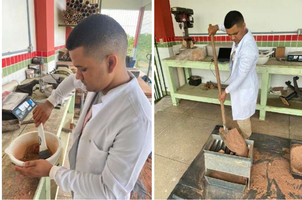
Figura 25 – Preparação de amostras para ensaios de caracterização de solo: (a) Destorroamento; (b) Repartição
