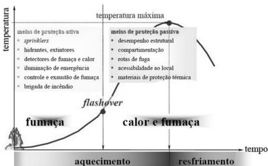
Figura 1 – Desempenho das medidas de proteção no comportamento do incêndio real
