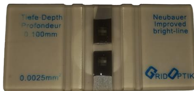
Figura 8 – Câmara de Neubauer
