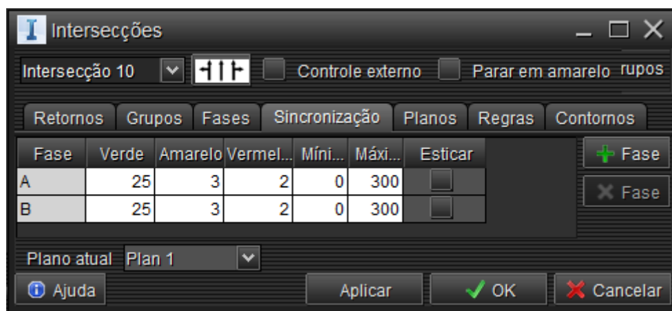
Figura 64. Determinação das durações dos intervalos luminosos para a IJ. Fonte: Captura de tela do Infracore.
