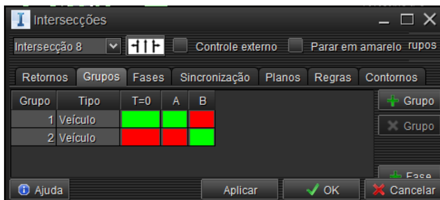
Figura 62. Definição dos grupos de semáforo e seus intervalos luminosos. Fonte: Captura de tela do Infraworks .
