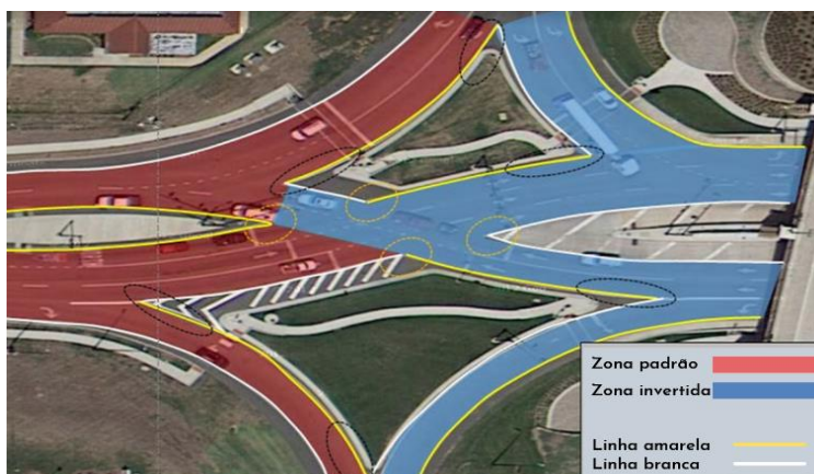
Figura 21. Alocação das linhas de sinalização horizontal. Fonte: FHWA (2014) - adaptado.
