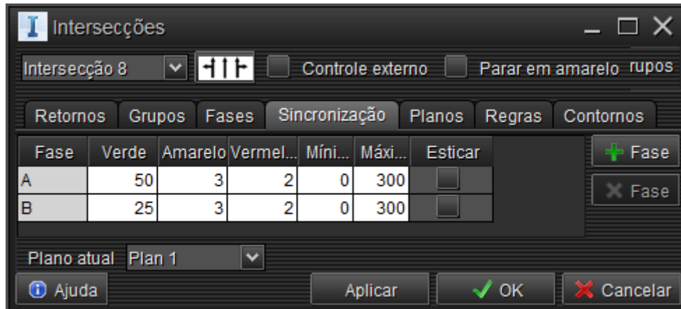
Figura 63. Determinação das durações dos intervalos luminosos para a IM. Fonte: Captura de tela do Infracore.
