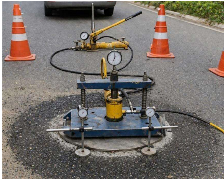
Figura 9 - Ensaio de placa de carga em pavimento
