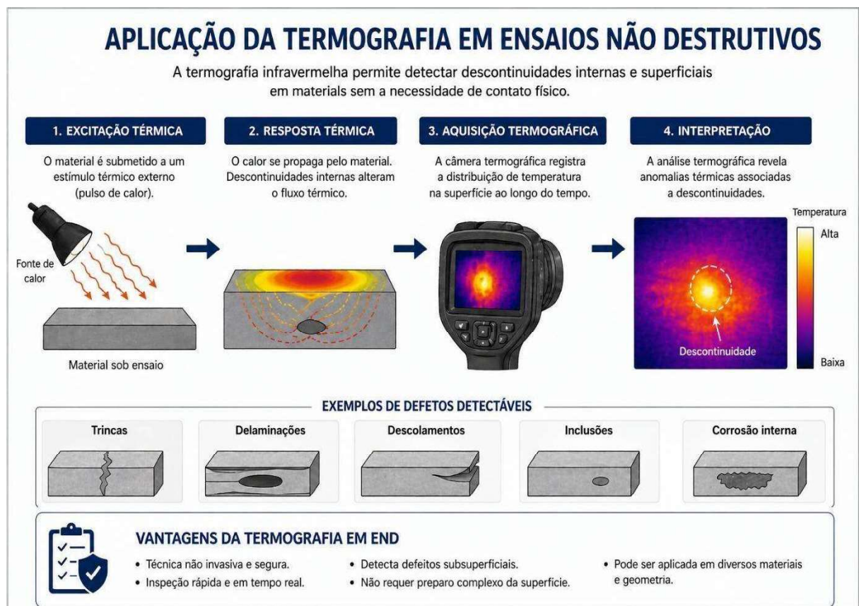
Figura 14 - Aplicação da termografia em ensaios não destrutivos
