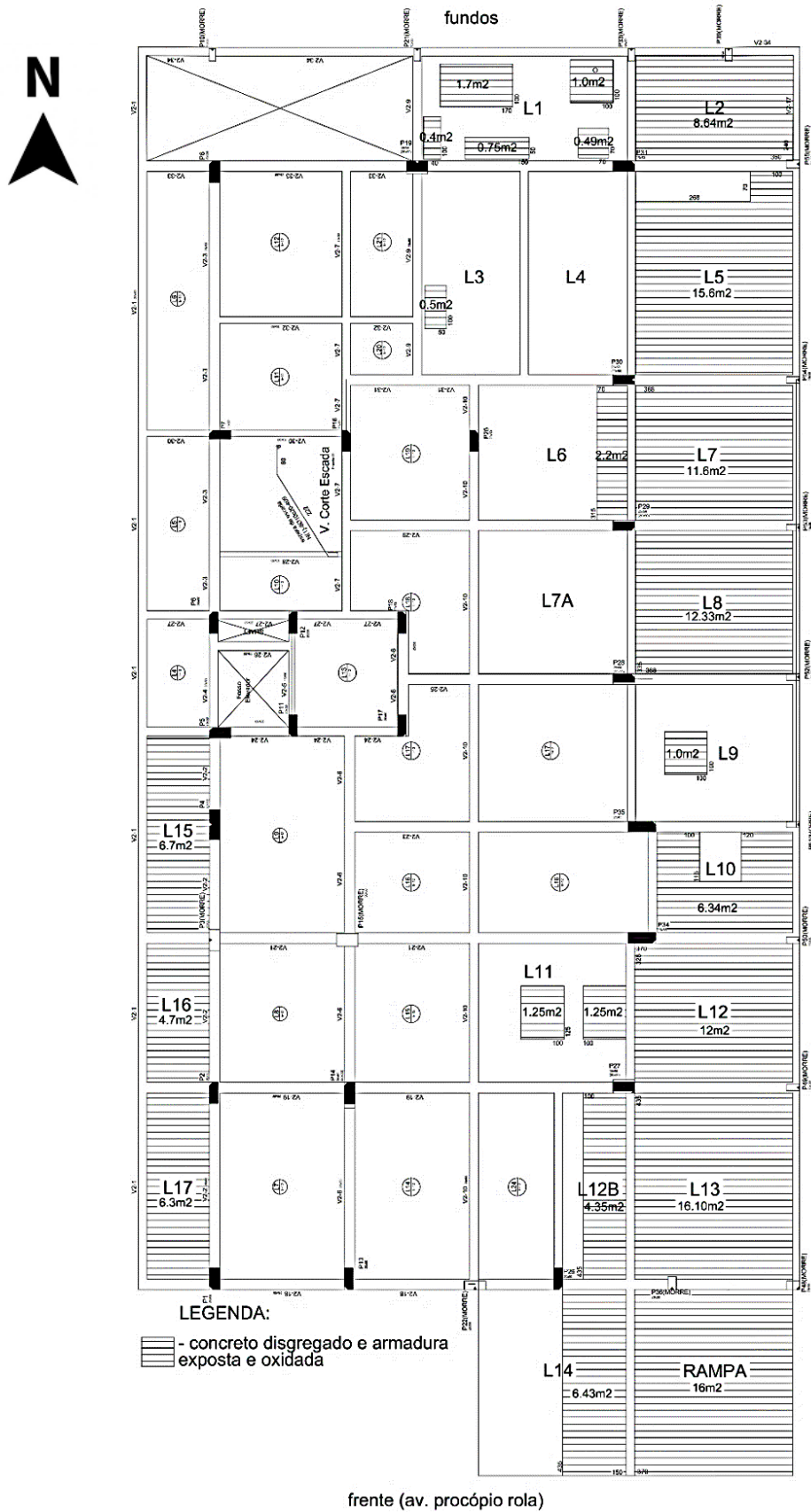
ANEXO A - CROQUIS COM MAPEAMENTO DAS ANOMALIAS NAS LAJES DO PAVIMENTO TÉRREO - EDIFÍCIO SALES
