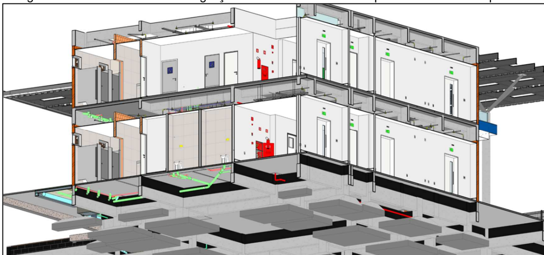
Figura 98 - 01 Corte 3D e a integração entre os sistemas complementares e a Arquitetura
