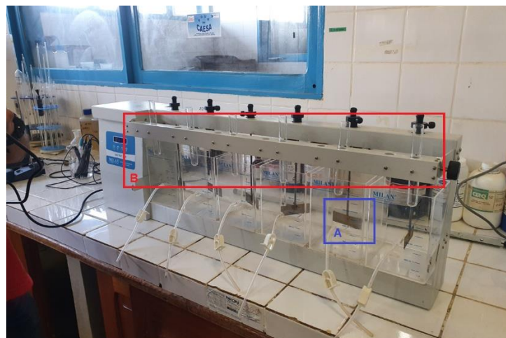
Figura 12: Equipamento para ensaio de Jar Test CAESA com seis réplicas utilizadas simultaneamente.
