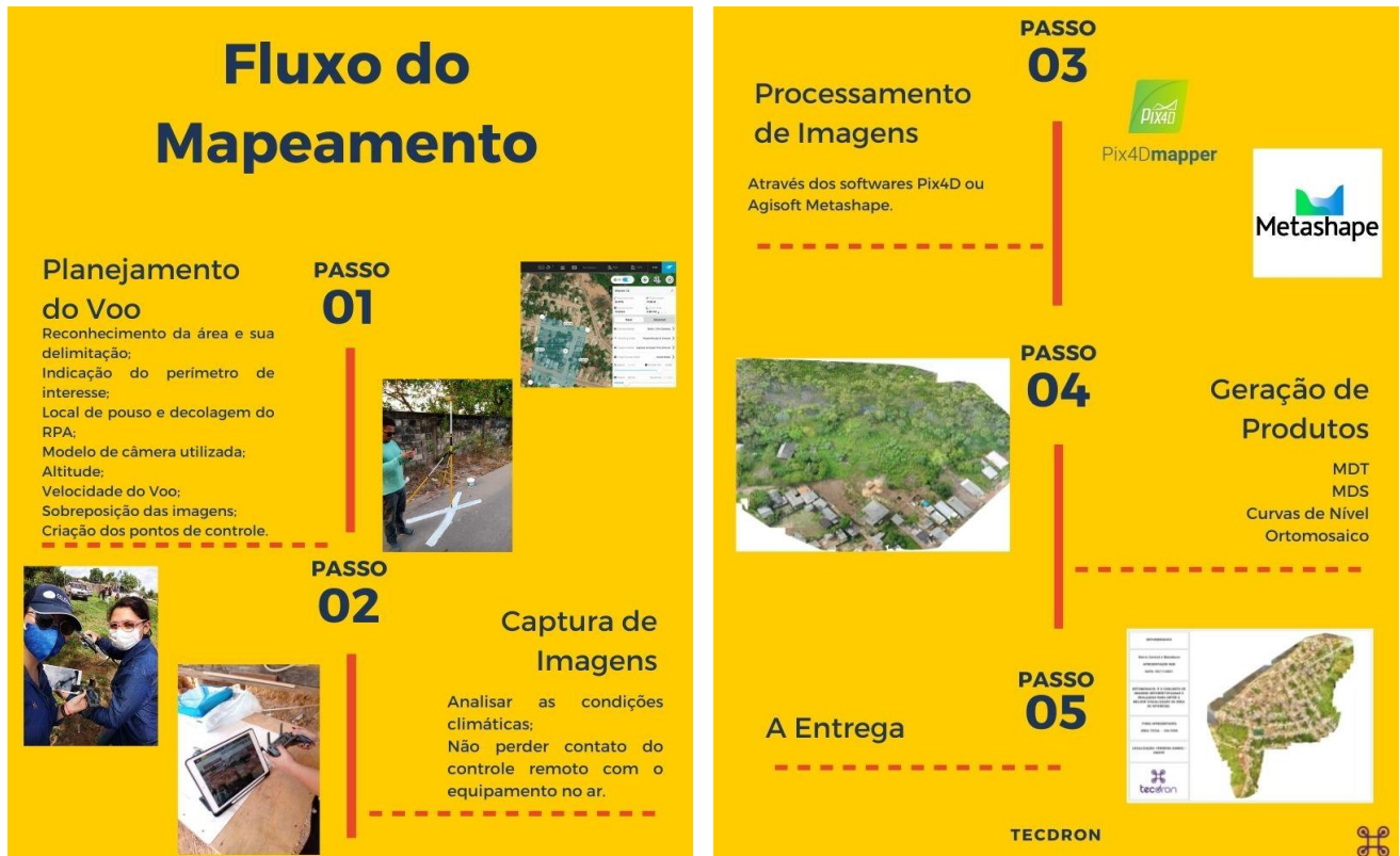
Figura 4. Organograma do Fluxo do Mapeamento. Fonte: TECDRON
