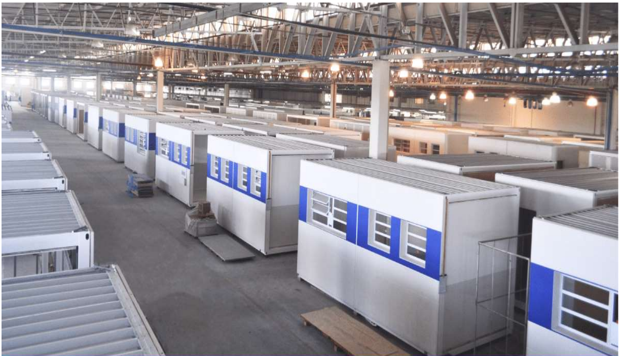
Figura 8: Galpão para fabricação de componentes off-site.
