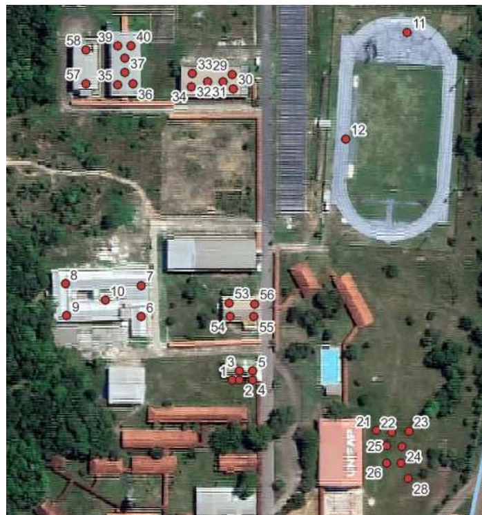
Figura 14 – Identificação dos furos de sondagem
