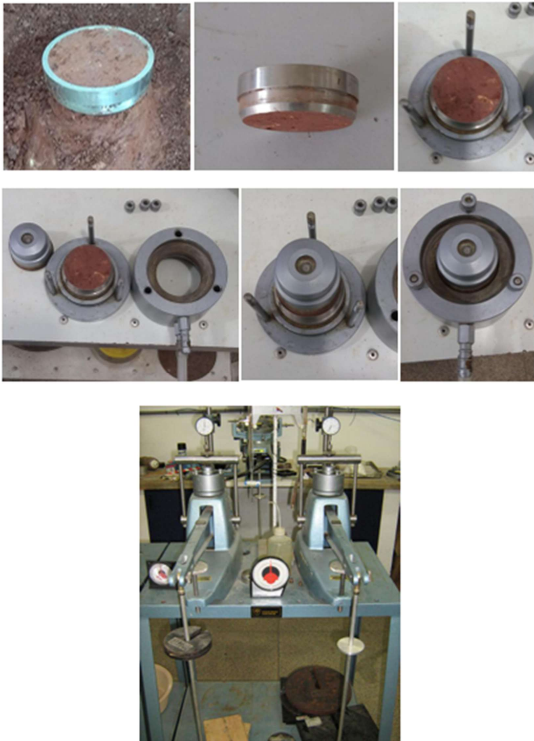
Figura 34 – Registro de etapas do ensaio de adensamento clássico no laboratório da UENF.
