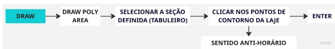
Figura 70 - Fluxograma para modelagem de laje através do grid
