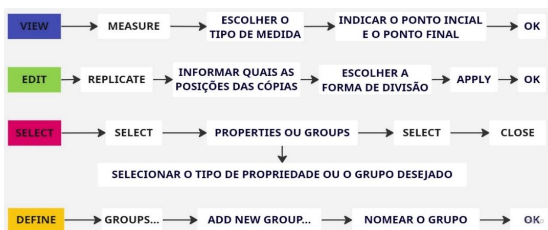
Figura 79 - Fluxograma para comandos auxiliares de modelagem
