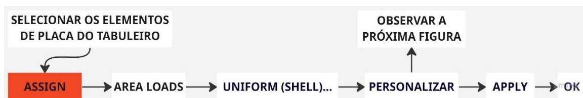
Figura 97 - Fluxograma para inserir a carga de pavimentação
