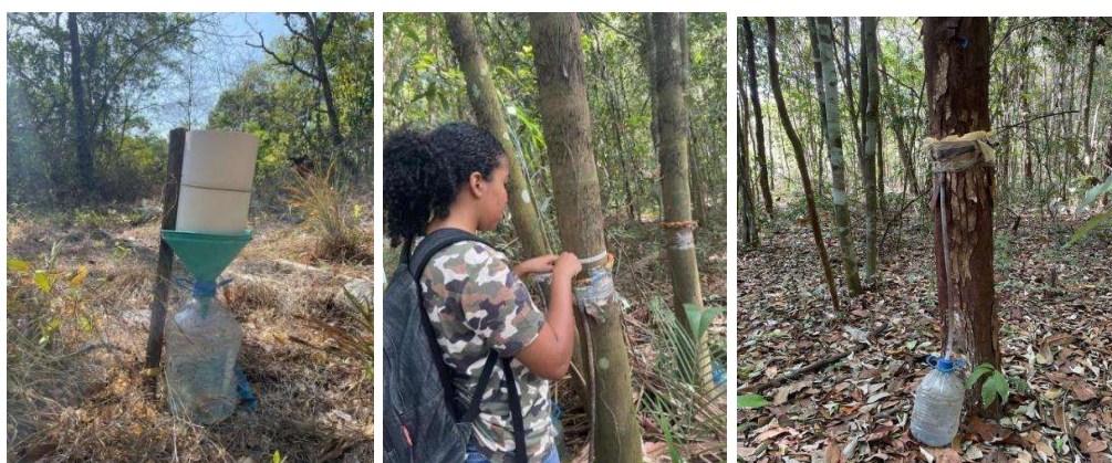
Figura 2. (a) Pluviômetro para precipitação em aberto; (b) Coletor de EPT; (c) Armazenamento. Fonte: Autores, 2023.
