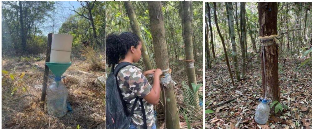
Figura 2. (a) Pluviômetro para precipitação em aberto; (b) Coletor de EPT; (c) Armazenamento.
