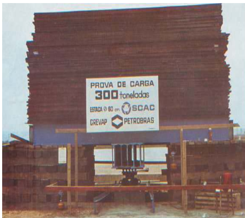
Figura 2.11 - Prova de carga em cargueira de chapas de aço.
