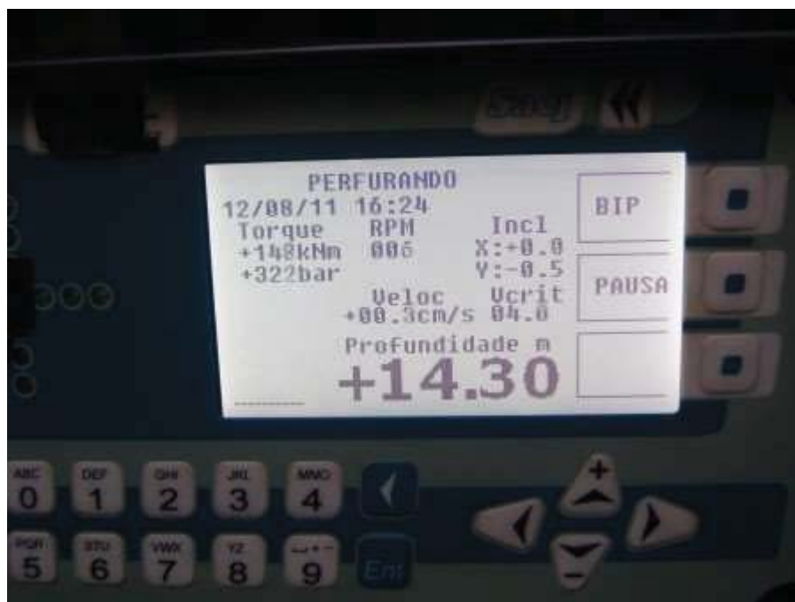
Figura 2.7 - Monitoramento da Execução de Hélice Contínua com Taracord.
