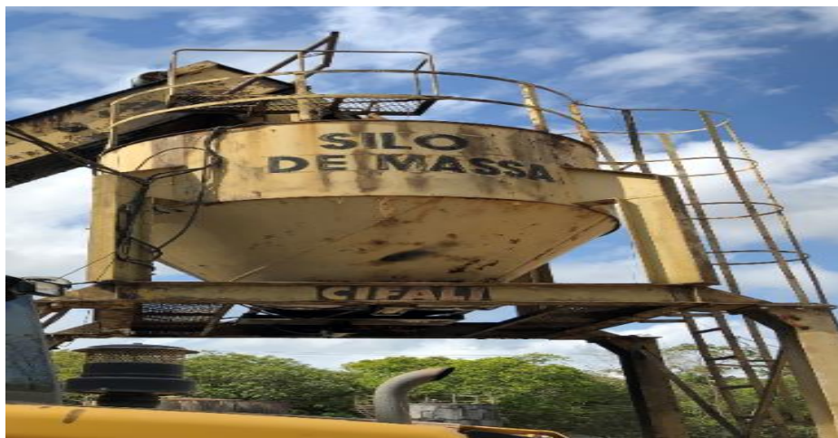
Figura 18 - Silo misturador Fonte: Os autores (2018)
