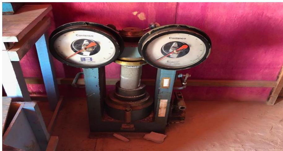
Figura 40 – Ensaio de rompimento do corpo de prova Fonte: Os autores (2018)
