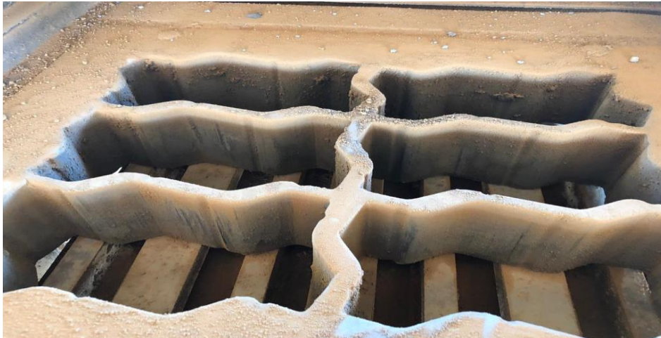
Figura 33 – Molde ou fôrma para bloco 16 faces Fonte: Os autores (2018)
