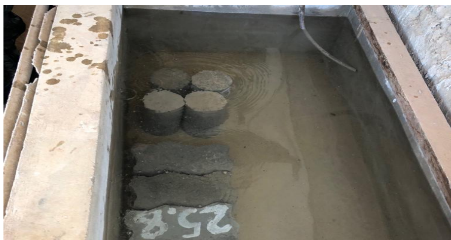
Figura 41 – Tanque de imersão de corpo de prova Fonte: Os autores (2018)
