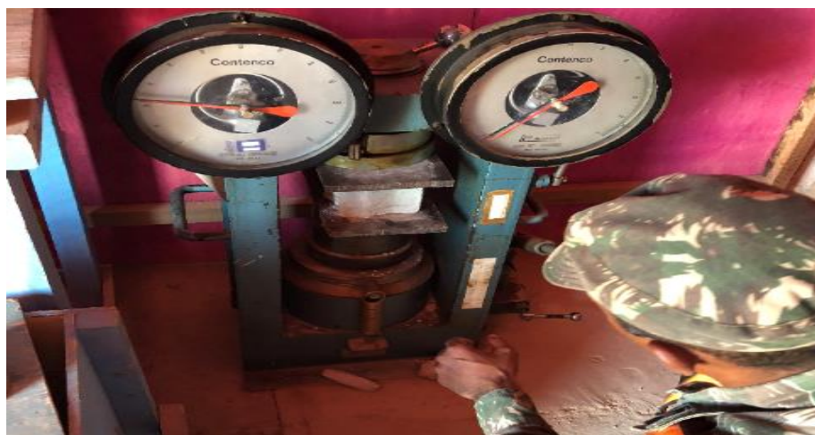
Figura 39 – Ensaio de rompimento do bloquete Fonte: Os autores (2018)
