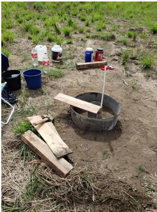
Imagem 37: Ponto do ensaio 2 - raspagem superficial do terreno e posicionamento dos instrumentos.
