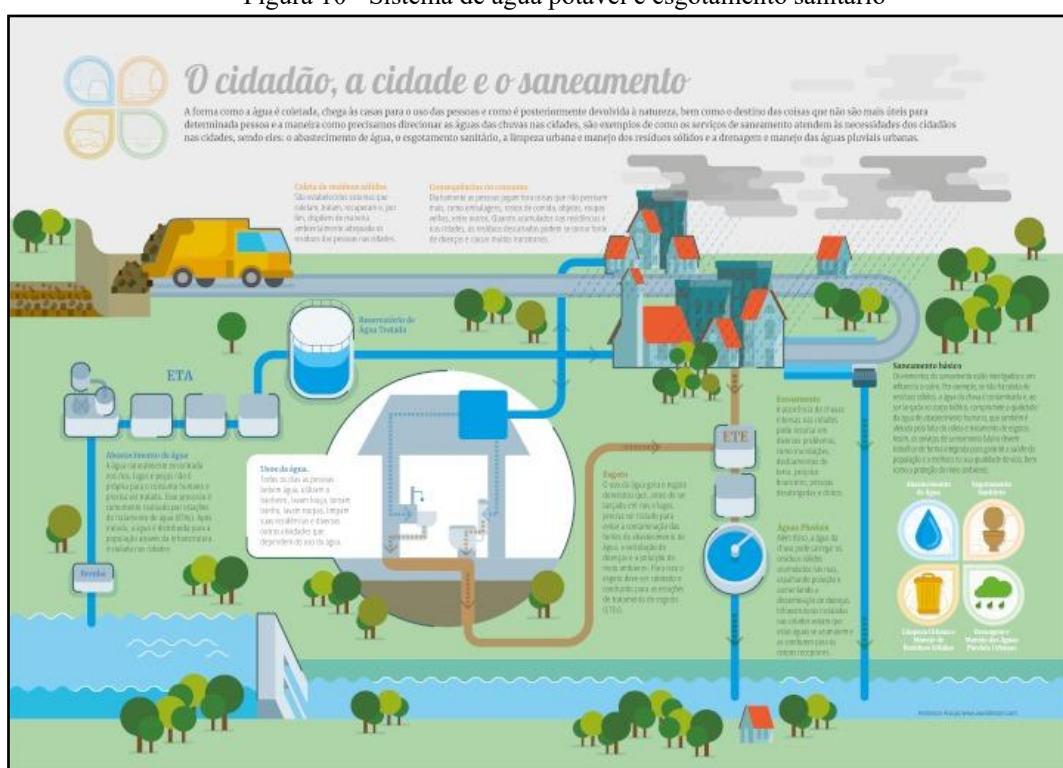
Figura 10 - Sistema de água potável e esgotamento sanitário
