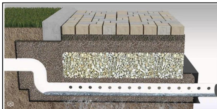
Figura 19-Estrutura do pavimento permeável
