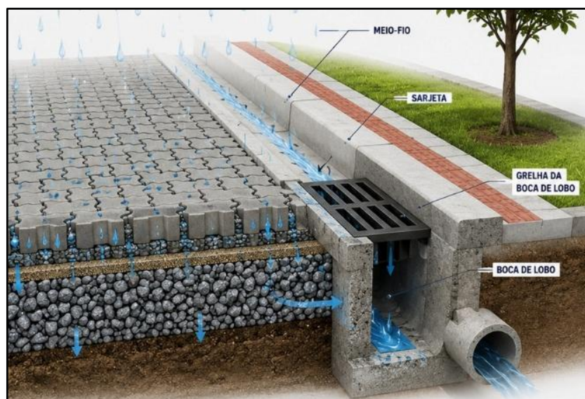
Figura 28- Exemplo de estrutura de pavimentos permeáveis
