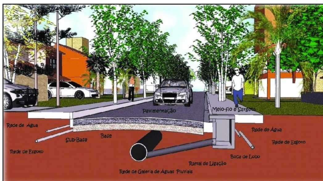
Figura 13-Exemplo de integração do sistema de microdrenagem com as redes de infraestrutura urbana
