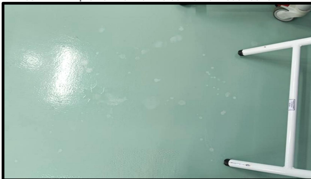
FIGURA 4 - REAÇÃO DO PISO EPÓXI AO COMPOSTO ÁLCOOL COMUM 70%
