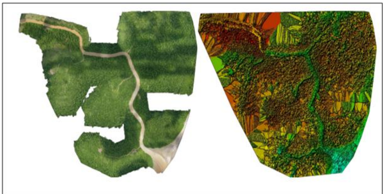
Figura 4. Ortomosaico e o Modelo Digital da Superfície (MDS) gerados
