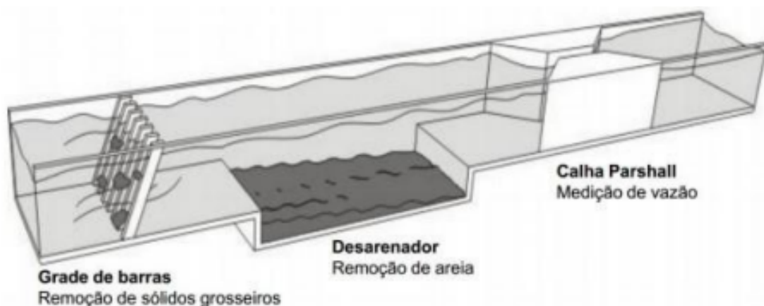
Figura 3: Representação esquemática das etapas físicas da ETE
