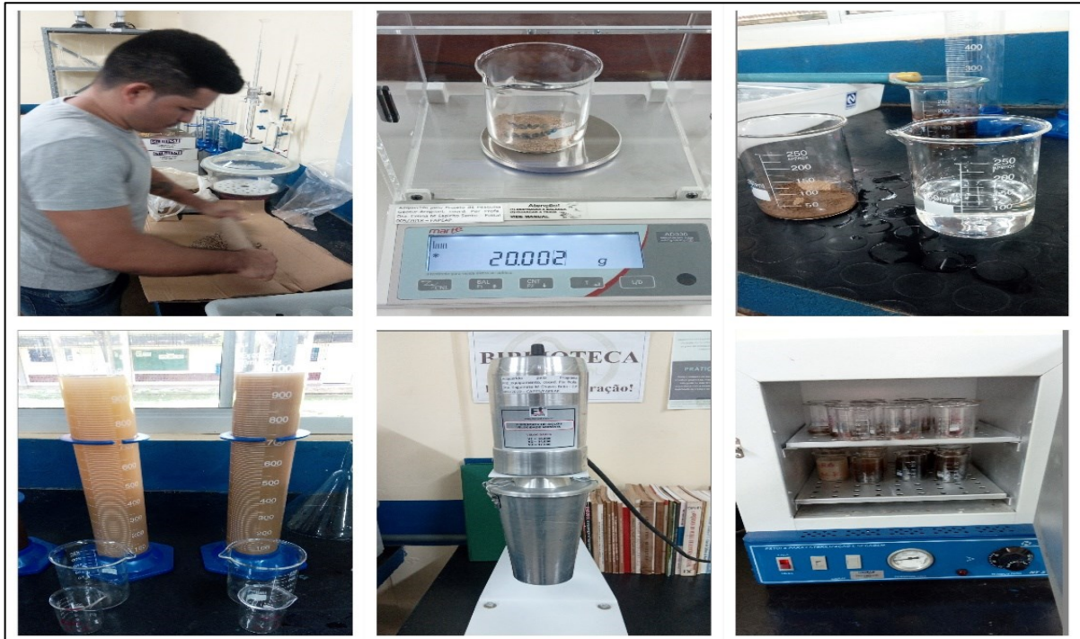
Figura 6 - Preparo das amostras de solo durante a análise granulométrica
