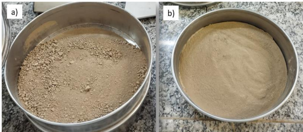
Figura 3 - Lodo de ETA: a) Processo de peneiramento; b) Resíduo peneirado
