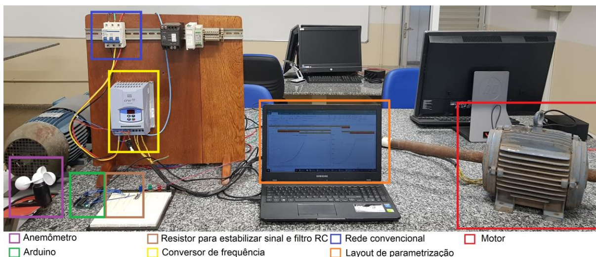
Figura 16 – Equipamentos utilizados para a montagem da bancada.
