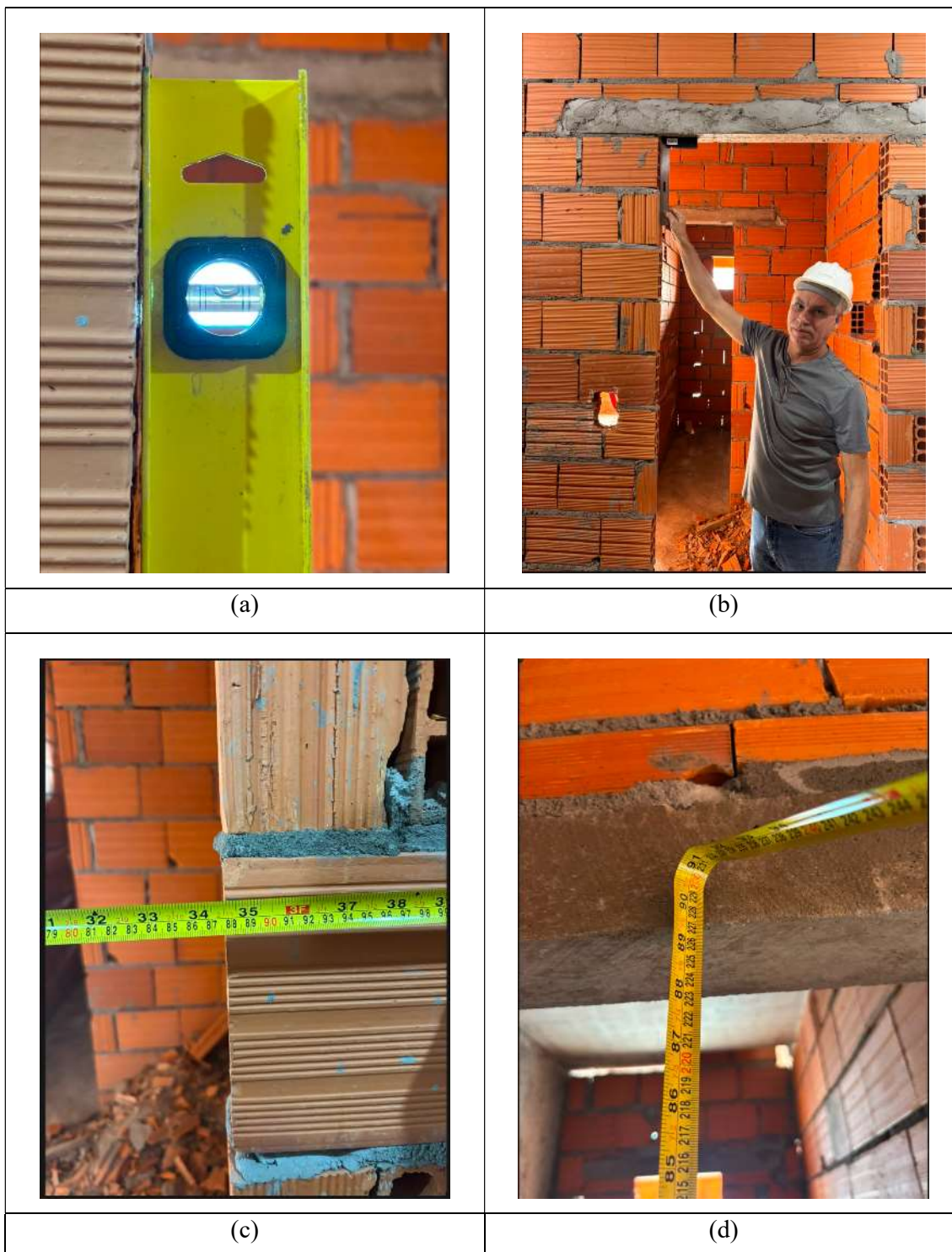
Figura B8 — Ed. Studio Way. Vão 08: (a) nível; (b) esquadro; (c) largura e (d) altura.
