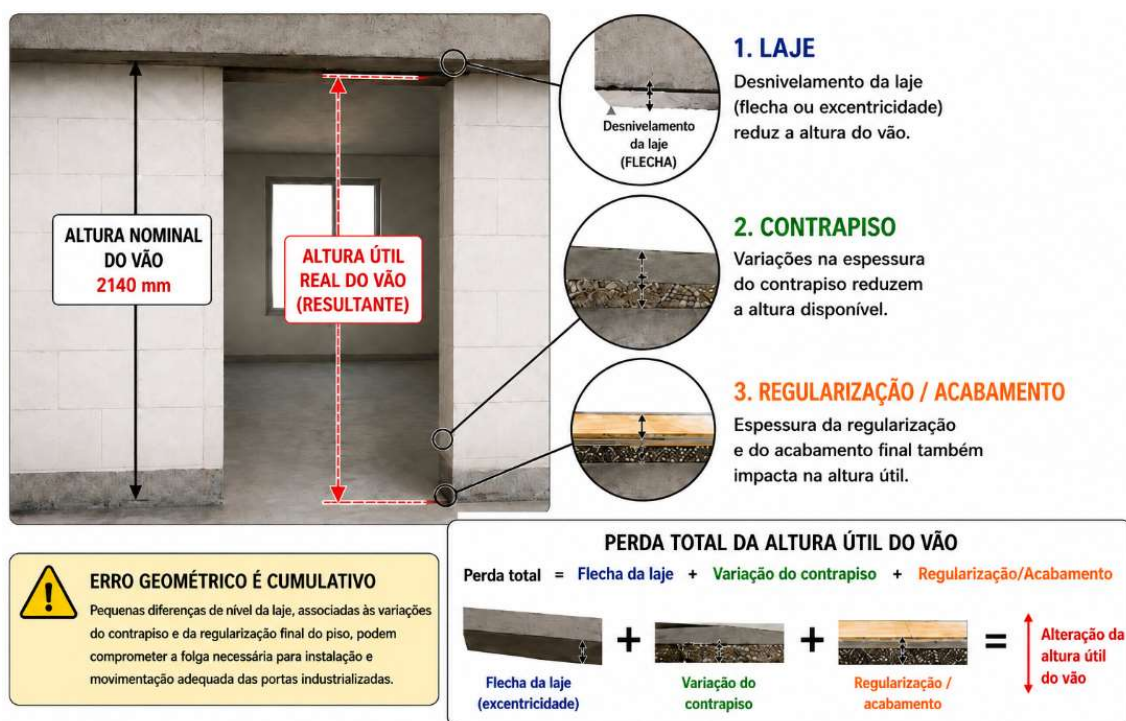
Figura 09 — Alteração da altura útil do vão devido à: (1) desnivelamento da laje; (2) variações no contrapiso; e (3) regularização e instalação de acabamento.
