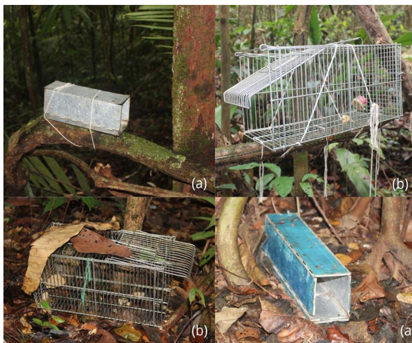
Figura 4: Armadilhas de contenção viva instaladas sobre o solo e no estrato arbóreo para captura de pequenos mamíferos não-voadores (a – Sherman, b – Gaiola).
